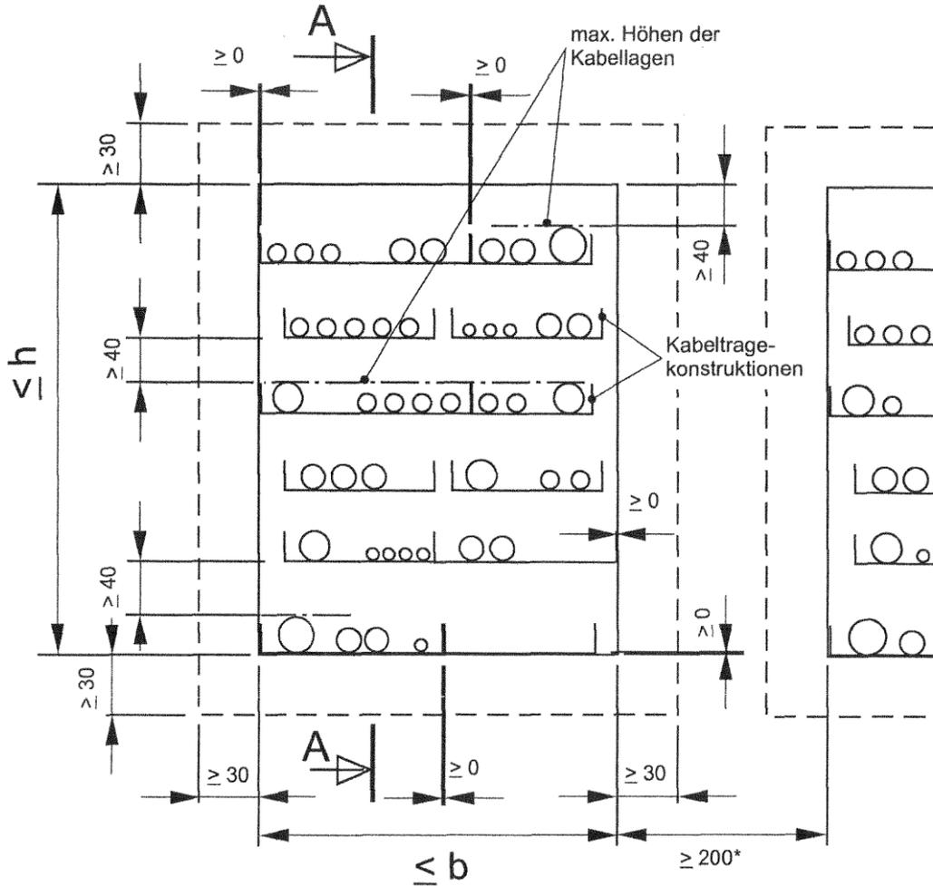
Außenmaße der Kabelabschottungen (Maximalabmessungen)
