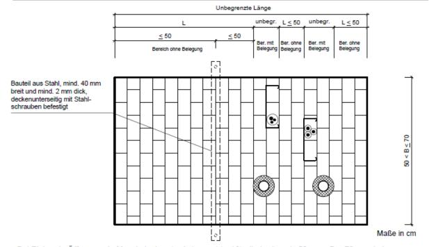
Bei Einbau in Öffnungen in Massivdecken (s. Anlagen 14 - 16), die breiter als 50 cm  $< B \le 70$  cm sind, muss in Abschottungen ohne Belegung bzw. in Bereichen ohne Belegung mit einer Länge L > 50 cm eine der folgenden Maßnahmen erfolgen (s.a. Abschnitt 4.4.7):
