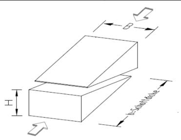
Der Nachinstallationskeil vereinfacht in schwierigen Einbaulagen das nachträgliche Öffnen der Kabelabschottung. Die mit den Nachinstalltionskeilen belegte Schottfläche darf eine Größe 30 cm x 15 cm (B x H) nicht überschreiten.
