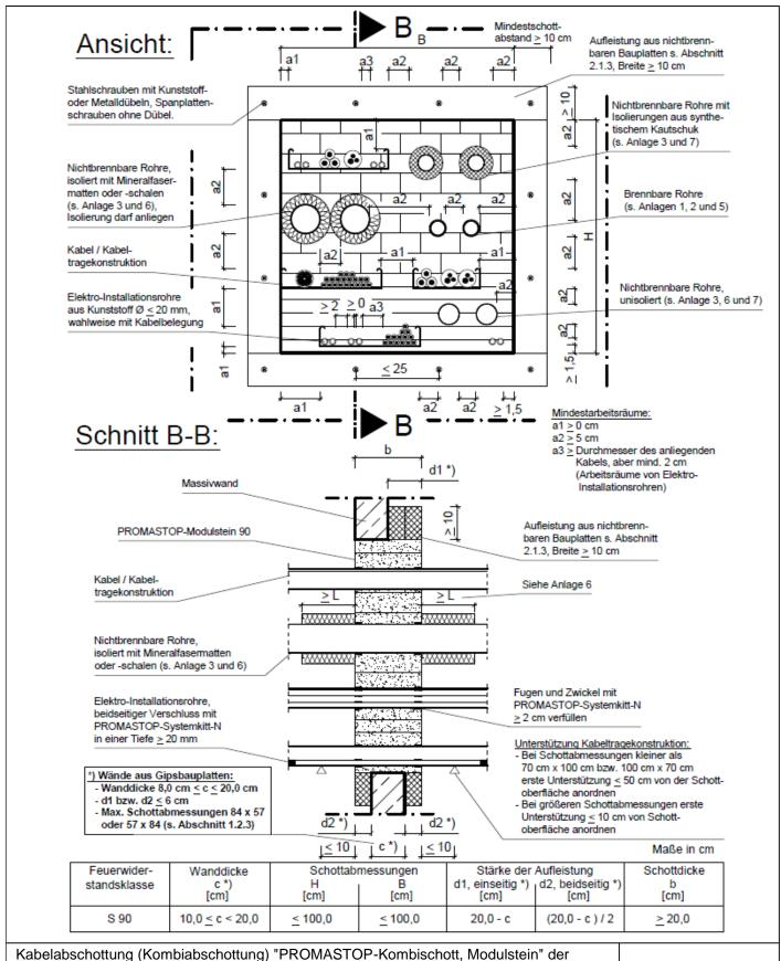
Kabelabschottung (Kombiabschottung) "PROMASTOP-Kombischott, Modulstein" der Feuerwiderstandsklasse S 90 nach DIN 4102-9
