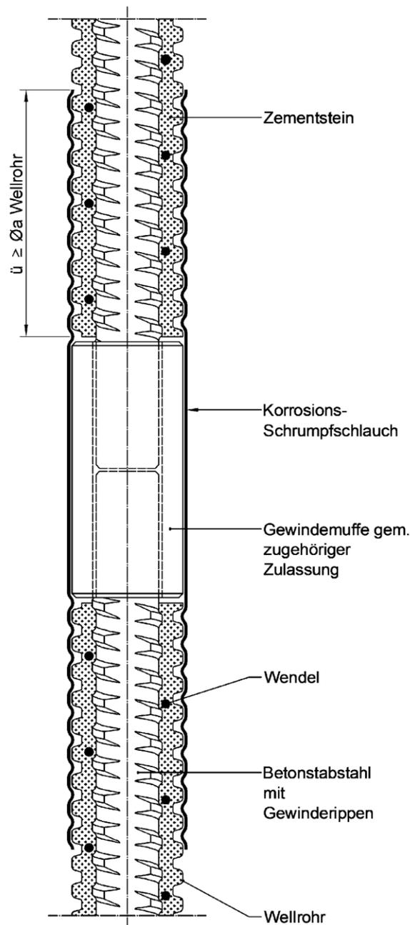
Muffenstoß mit Drehsicherung
