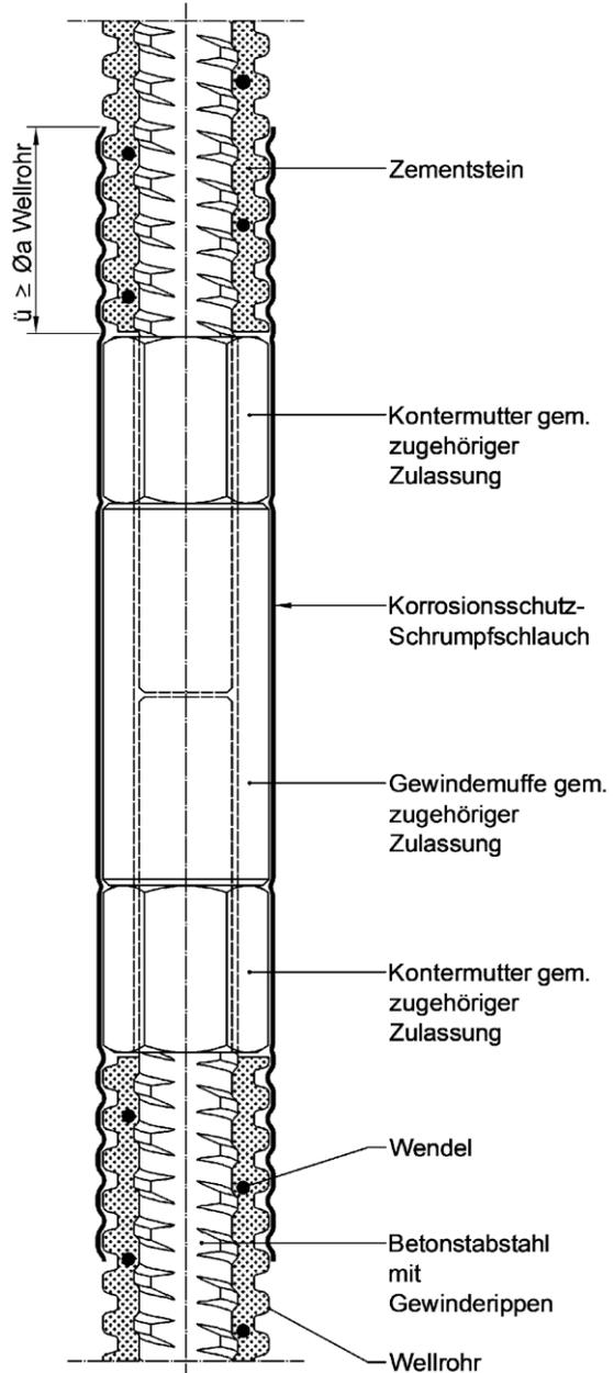
Abmessungen und Materialien der Gewindemuffen und Kontermuttern sowie Kontermomente gemäss allgem. bauaufsichtl. Zulassungen Z-1.5-76 und Z-1.5-149 und Z-1.5-174
