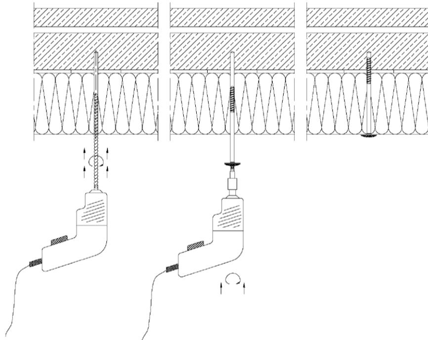
**Heraklith Betonschraube DDS, DDS plus, DDS-MW**
