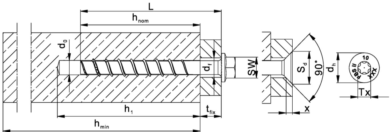
fischer Betonschraube ULTRACUT FBS II für temporäre Befestigungen
