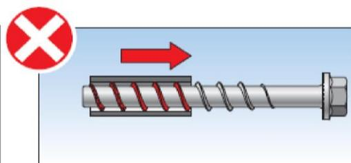
Sobald die Schraube über die Stirnseite der Hülse herausragt, ist die Schraube für eine Wiederverwendung nicht mehr geeignet.
