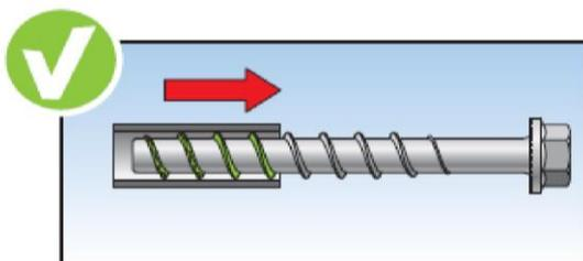
Die Betonschraube ist vor jeder Verwendung auf sichtbare Beschädigungen zu prüfen (z. B. Korrosion) und gegebenenfalls auszutauschen.
