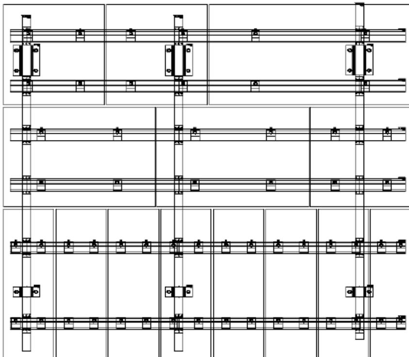
Rückseitige Befestigung von betoShell-Fassadenplatten mittels fischer Zykon-Plattenanker FZP II auf Unterkonstruktionen
