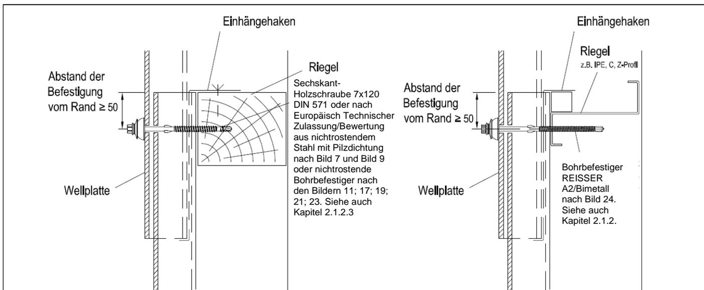
Bild 25: Anordnung der Befestigung auf dem Wellenberg auf Holz-Unterkonstruktionen
