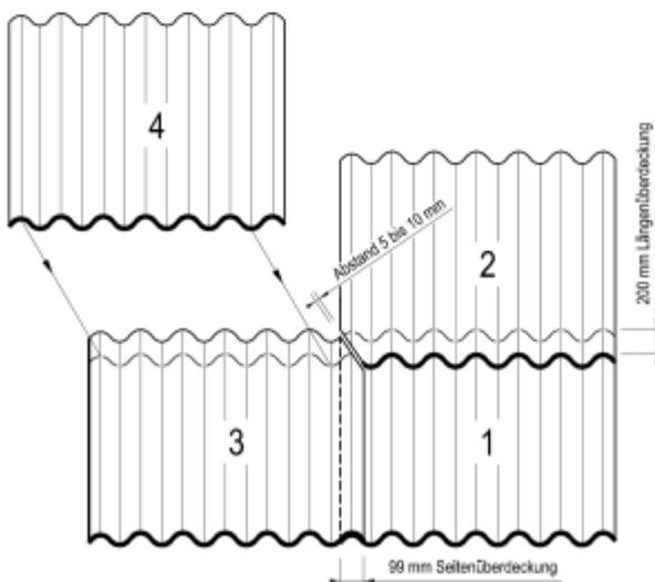
**Bild 6:** Überdeckungen und Eckschnitte der Platte P6 $\frac{3}{4}$ . Die Nummerierung der Wellplatten (1 bis 4) kennzeichnet die Reihenfolge bei der Verlegung
