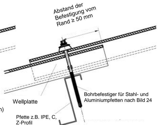
**Bild 8b:** Anordnung der Befestigung auf Stahl- oder
