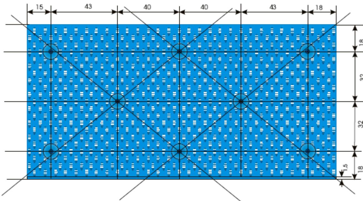
Beispiel: Anordnung der Dübel bei Anwendungen mit 4 Dübel/m<sup>2</sup>
