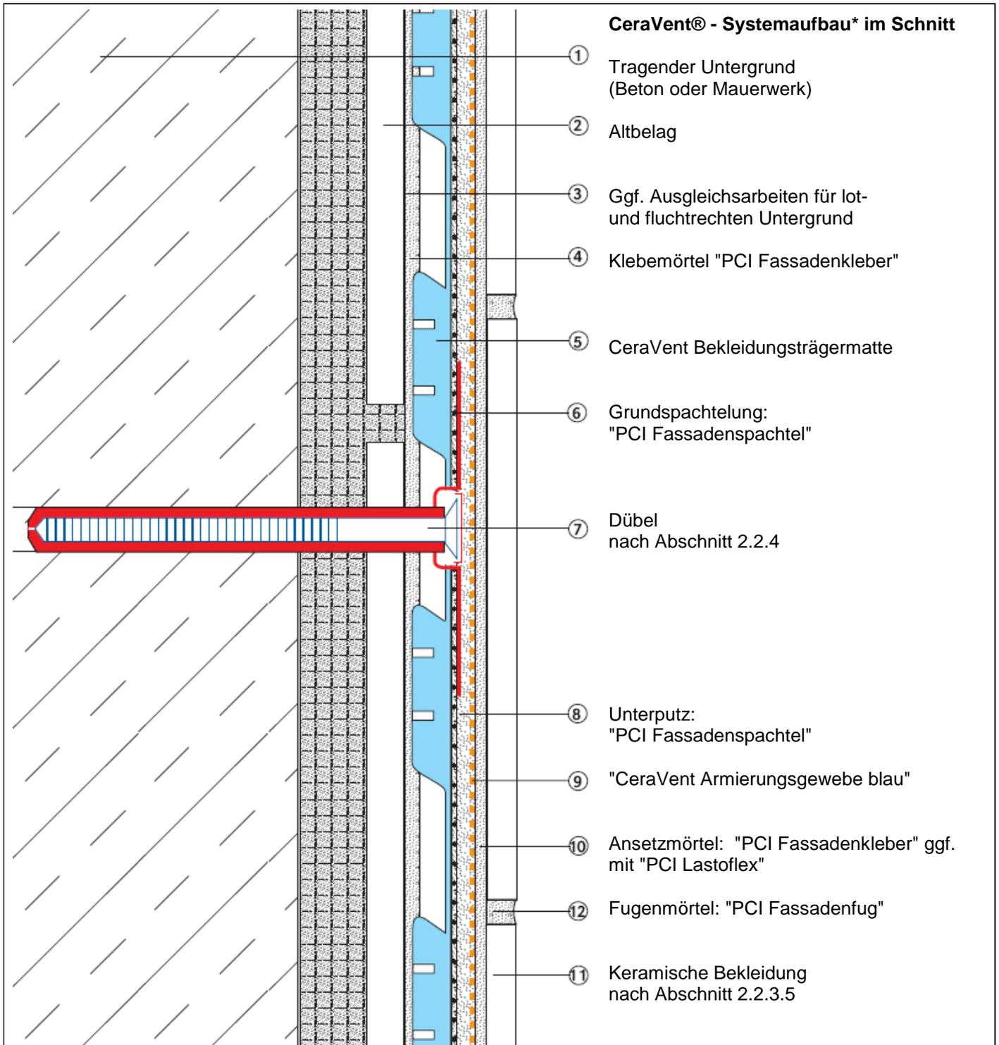
\* Alternative Ausführungen (gemäß Abschnitt 1.2): Montage auf vorhandene WDVS oder auf vormontierte Dämmstoffplatten aus Mineralwolle (MW). Die Dübel sind durch das WDVS bzw. durch die Dämmplatten hindurch in den tragenden Untergrund (Beton oder Mauerwerk) zu verankern.
