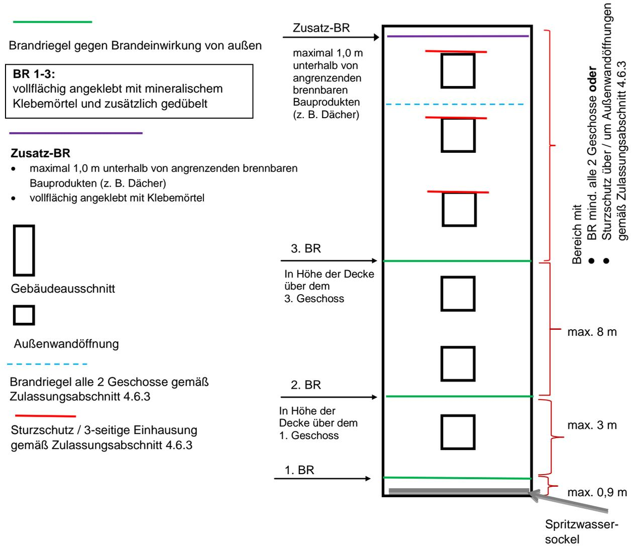
Anordnung der konstruktiven Brandschutzmaßnahmen
