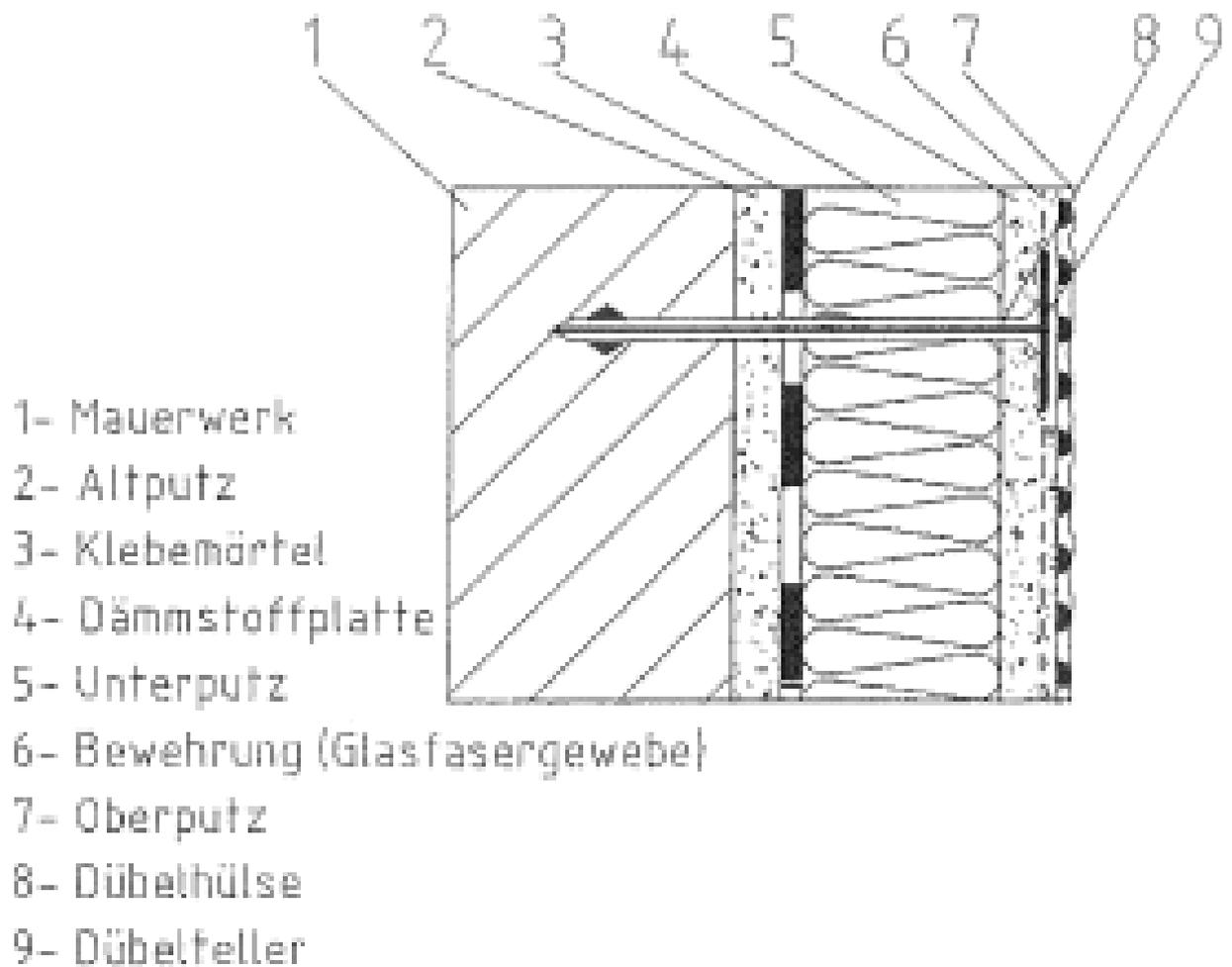
Aufbau des schwerentflammaren WDVS
