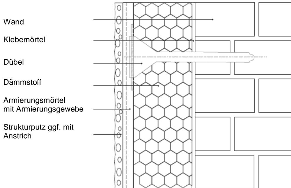
Teilflächige Verklebung der Mineralfaser-Lamellendämmplatten:
