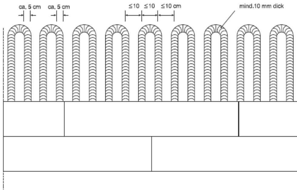
**Aufbau des WDVS mit EPS-Platten
