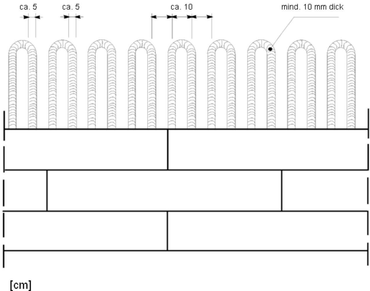
**Wärmedämm-Verbundsystem mit angeklebten
