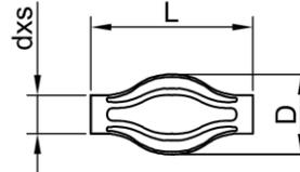
Muffenstoß (mit Drehsicherung wahlweise)
