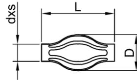
Muffenstoß (mit Drehsicherung wahlweise)
