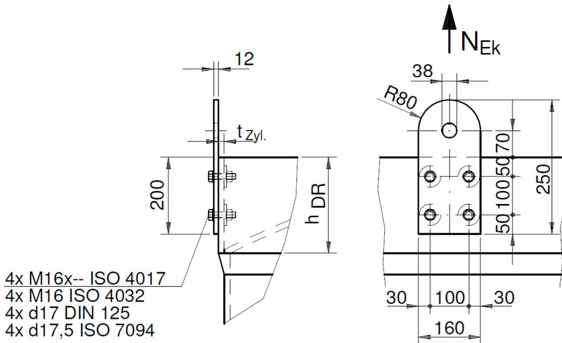
Ist der obere Zargenring  $h_{DR}$  höher als 250 mm und mit einem Ausschnitt versehen, so sind die Hebeösen soweit wie möglich von diesem Ausschnitt entfernt anzuordnen und die Zarge mit einer Aussteifung zu versehen.
