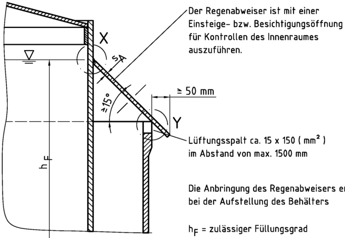
Die Anbringung des Regenabweisers erfolgt bei der Aufstellung des Behälters
