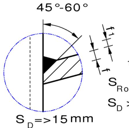
$S_{Rohr} > S_D : f_1 = 0,5 \times S_{Rohr}$
