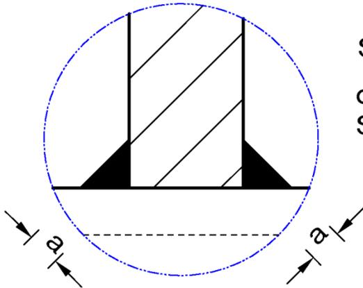
$S_{\text{Rohr}} > S_{zF} : a = 0,7 \times S_{\text{Rohr}}$
