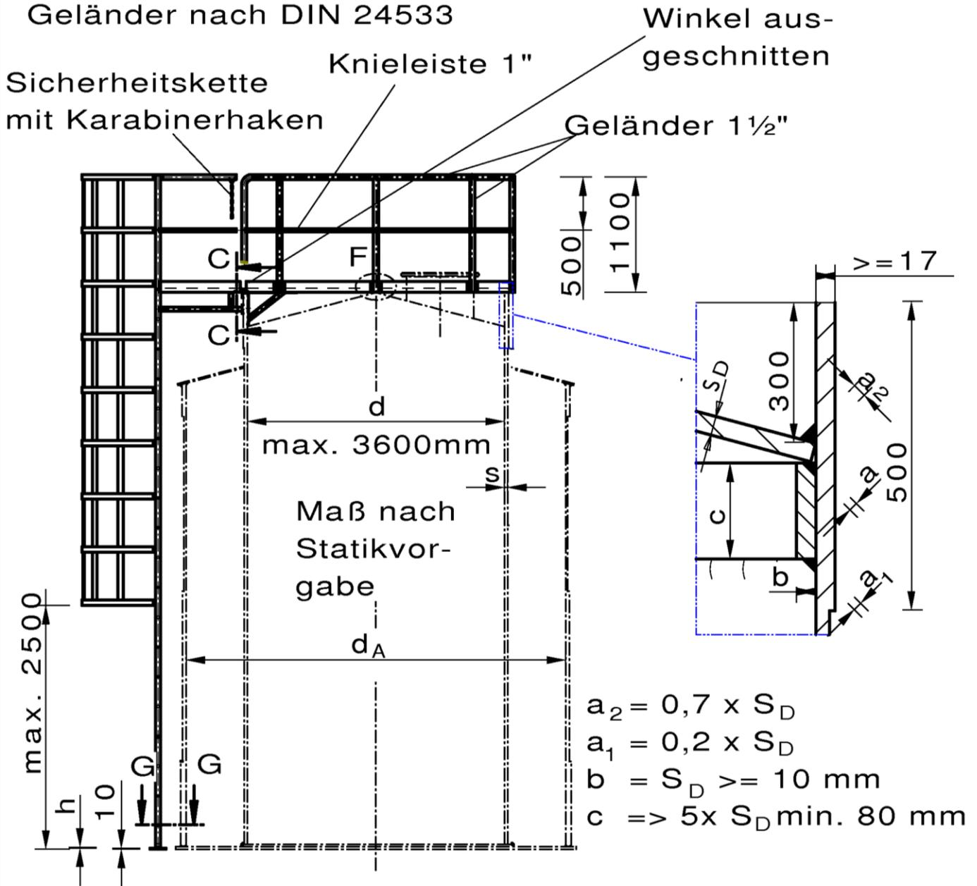
Letzte Sprosse in Rosthöhe der Gitterbühne. Von dort aus mit Abstand 280 mm nach unten. Maß "h" am Leiterfuß muß ausreichend groß zur Kompensation von Temperaturschwankungen und Ausgleich unterschiedlicher Behälterhöhen sein. Das erforderliche Maß "h" ist nachzuweisen.
