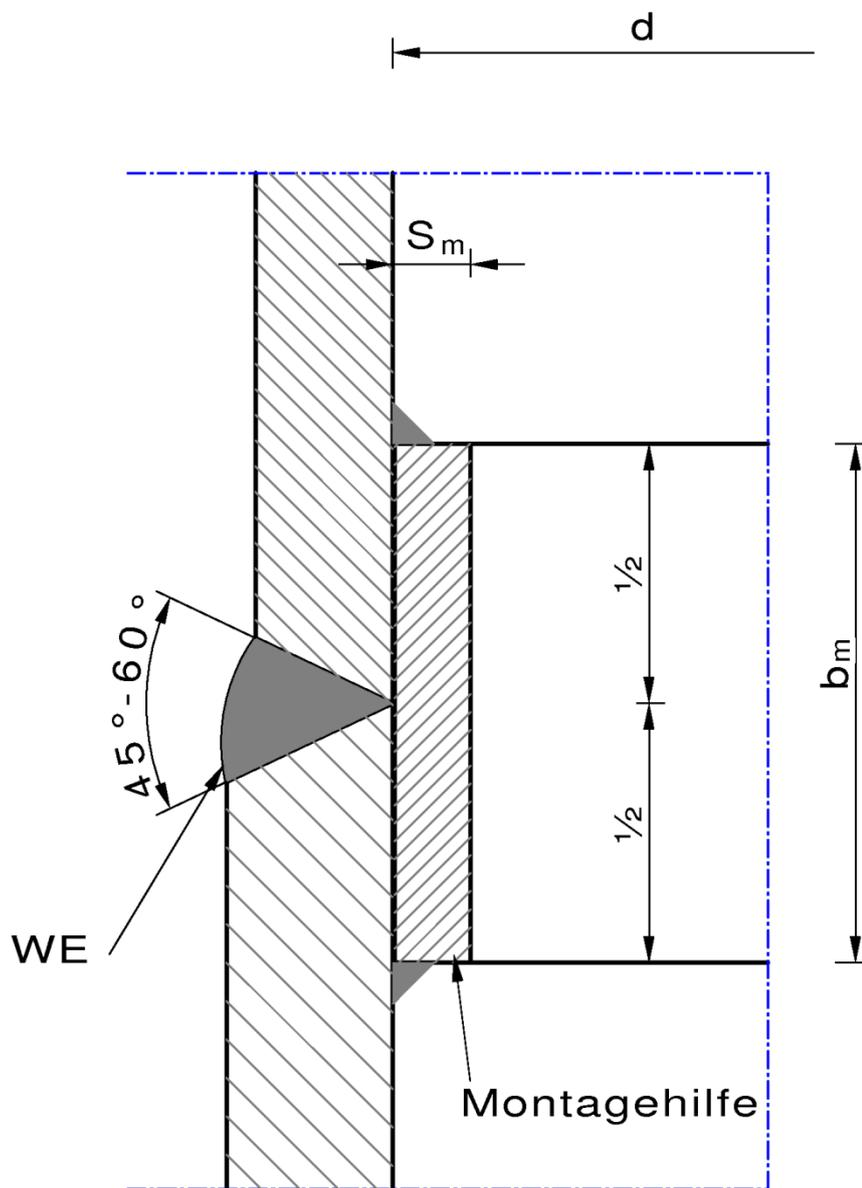
$S_m$  bis  $\varnothing 2000 \geq 5 \text{ mm}$
