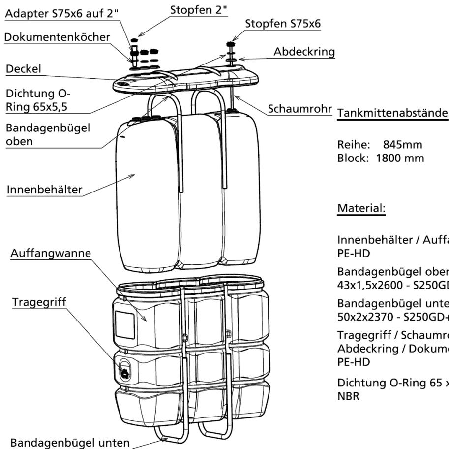
Blasgeformte Behälter mit integrierter Auffangvorrichtung aus Polyethylen (PE-HD) mit vertikalen verzinkten Stahlblechbandagen
