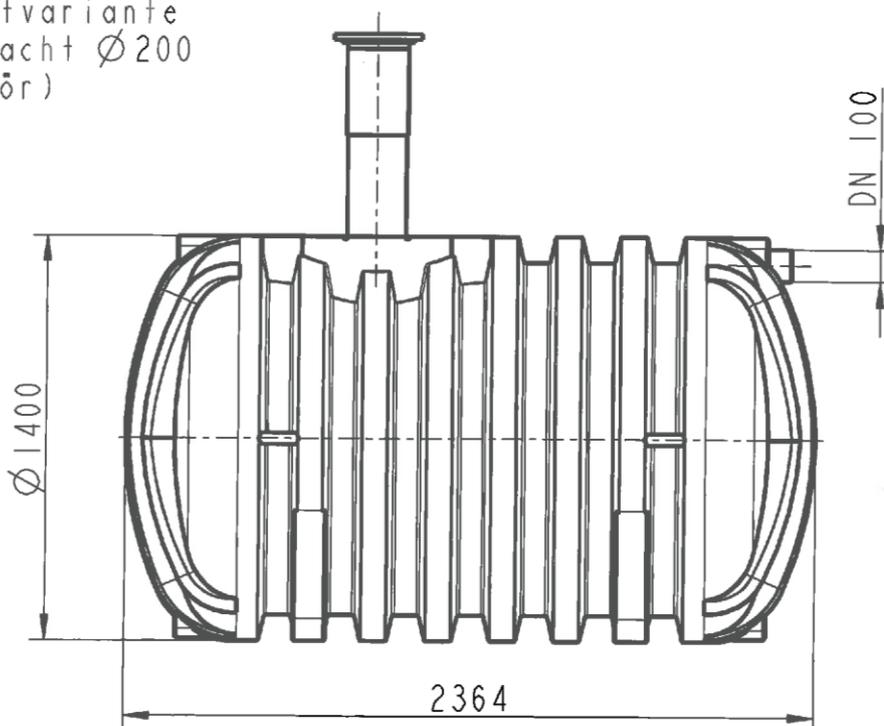
Abflusslose Sammelgrube aus Polyethylen (PE-LLD) für die Lagerung von häuslichem Abwasser 2000 l und 3000 l 2000 l und 3000 l
