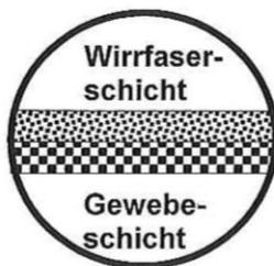
Kurzlinungsverfahren mit der Bezeichnung "Konudur LM-Liner" zur Sanierung schadhafter erdverlegter Abwasserleitungen im Nennweitenbereich von DN 100 bis DN 500
