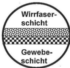
Kurzlinungsverfahren mit der Bezeichnung "Konudur LM-Liner" zur Sanierung schadhafter erdverlegter Abwasserleitungen im Nennweitenbereich von DN 100 bis DN 500
