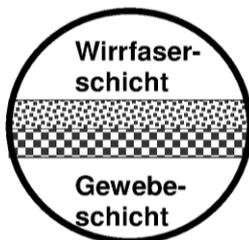
Kurzlinierverfahren mit der Bezeichnung "pmt - Kurzliner" zur Sanierung schadhafter erdverlegter Abwasserleitungen im Nennweitenbereich von DN 100 bis DN 500
