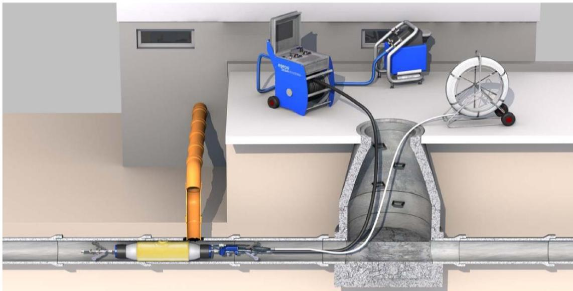
Den an der DrainLCR-Steuerbox befindlichen Hebel „Air/Vacuum“ kurzzeitig auf „Air“ drehen. Den DrainLCR-Packerkorb anheben, indem der Hebel „Pathfinder“ auf „up“ gedreht wird. Der LCR-S-Packerkorb hebt sich gegen die Rohrwand.
