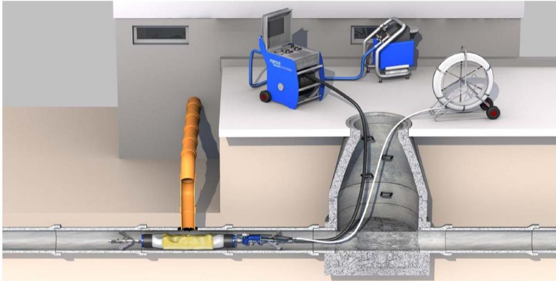
DrainLCR-S-Packer hinter den Stützen schieben bzw. ziehen. Mit Hilfe der Kamera und des Drehantriebes den DrainLCR-S-Hebekorb in einer Flucht zum Seitenanschluss ausrichten.
