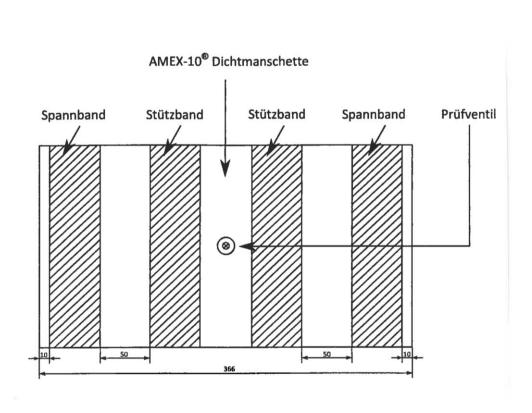
Innendicht- und Linerendmanschette mit der Bezeichnung "AMEX®-10 MONO" in den Nennweiten DN 150 bis DN 4000
