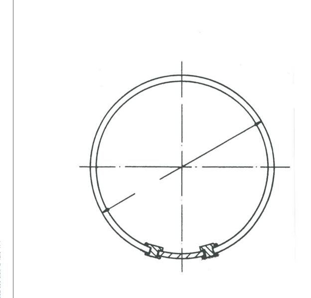
Innendicht- und Linerendmanschette mit der Bezeichnung "AMEX®-10 MONO" in den Nennweiten DN 150 bis DN 4000
