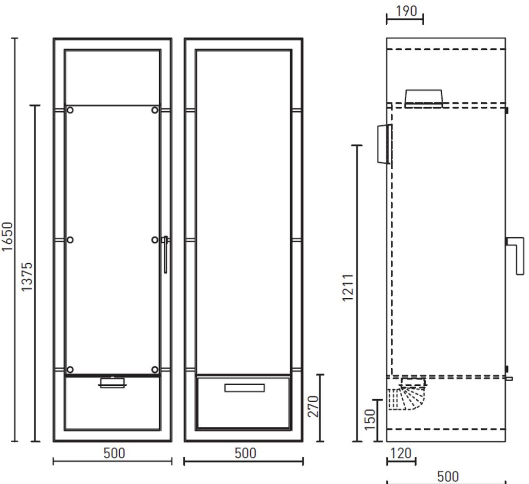
Raumluftunabhängige Feuerstätte für den Brennstoff Scheitholz mit der Bezeichnung
