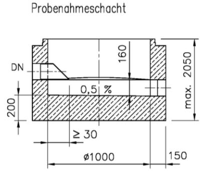
Behälter: Stahlbeton nach DIN 1045 und DIN 4281
