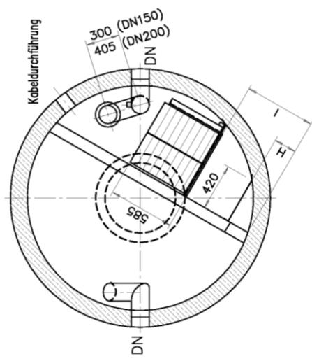
Abscheideranlage bestehend aus einem Abscheider Klasse I mit Koaleszenzeinrichtung und integrierten Schlammfang 3A-SK seglam
