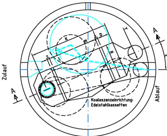
Standarddeckenöffnungen (U) im Behälter  $\phi A$  2500 : 1 x  $\phi$  1000, 2 x  $\phi$  800; alternativ bei Zulauftiefen unter 1,00 m : 3 x  $\phi$  625
