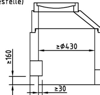
Abscheideranlage aus Beton, bestehend aus einem Abscheider Klasse I mit Koaleszenzeinrichtung, einem integrierten Schlammfang und einer Probenahmestelle; SEPARON
