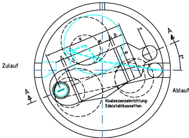
Standarddeckenöffnungen (U) im Behälter  $\phi A$  2500 : 1 x  $\phi$  1000, 2 x  $\phi$  800; alternativ bei Zulauftiefen unter 1,00 m : 3 x  $\phi$  625
