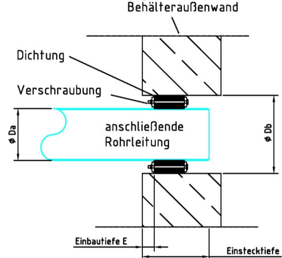
Rohrdurchführungen, Anschluss für Steinzeug Dichtelement BKK.
