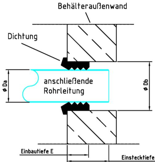
Rohrdurchführungen, Anschluss für Ringraumdichtung.
