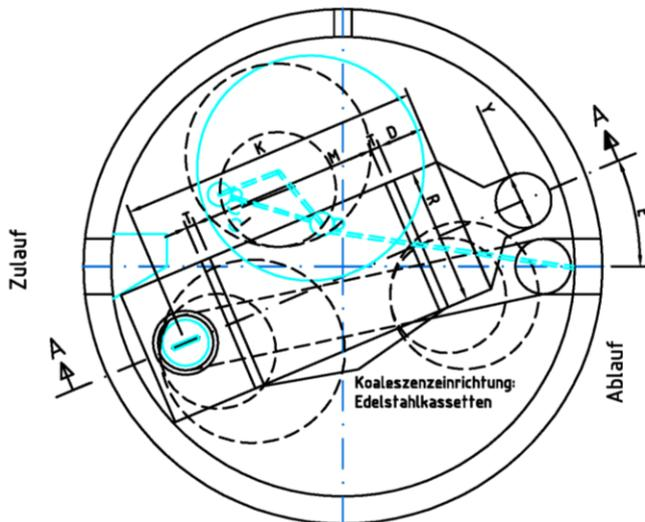
Standarddeckenöffnungen (U) im Behälter  $\phi A$  2500 : 1 x  $\phi$  1000, 2 x  $\phi$  800; alternativ bei Zulauffiefen unter 1,00 m : 3 x  $\phi$  625
