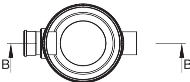
Abscheideranlage für Leichtflüssigkeiten Klasse I aus Kunststoff zum Erdeinbau
