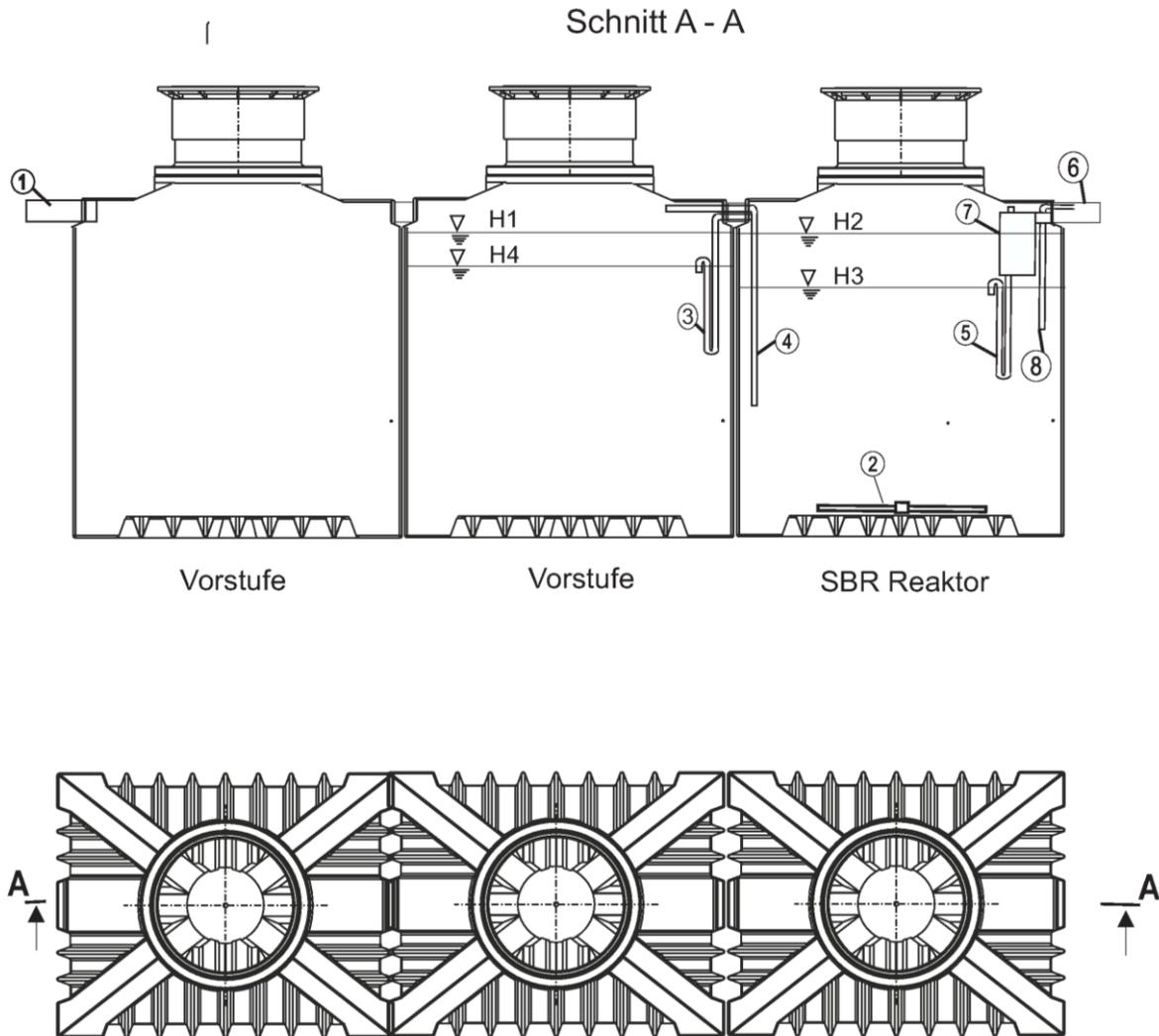
Die Rückstaufreiheit des Zulaufrohres ist sicherzustellen. Unterkante Notüberlauf sowie Unterkante Ablaufrohr dürfen nicht über Unterkante Zulaufrohr liegen.
