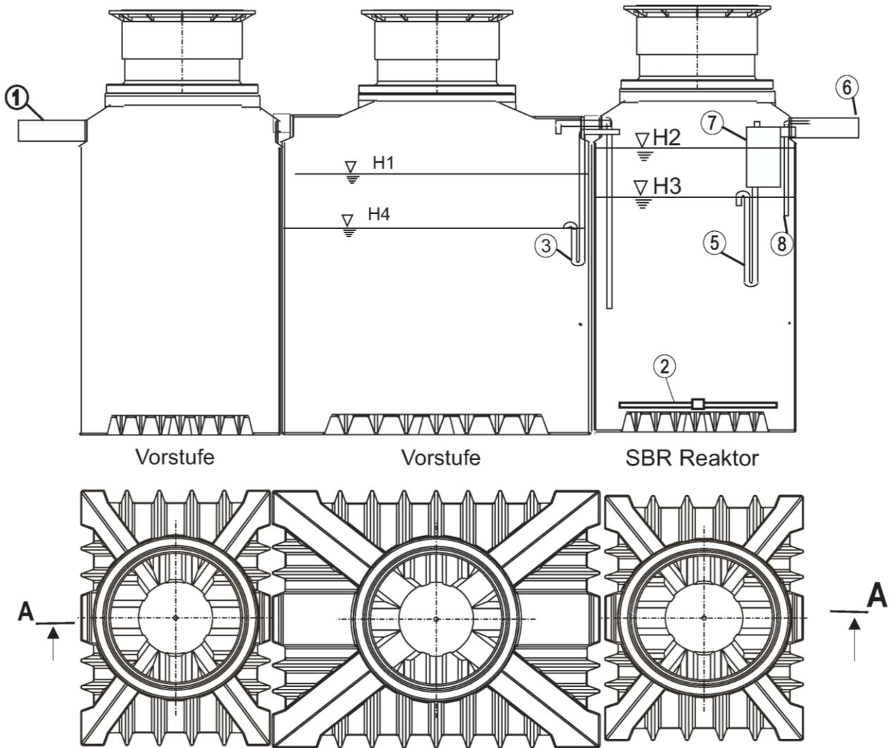
Die Rückstaufreiheit des Zulaufrohres ist sicherzustellen. Unterkante Notüberlauf sowie Unterkante Ablaufrohr dürfen nicht über Unterkante Zulaufrohr liegen.
