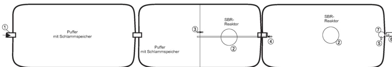
Die Rückstaufreiheit des Zulaufrohres ist sicherzustellen. Unterkante Notüberlauf sowie Unterkante Ablaufrohr dürfen nicht über Unterkante Zulaufrohr liegen.
