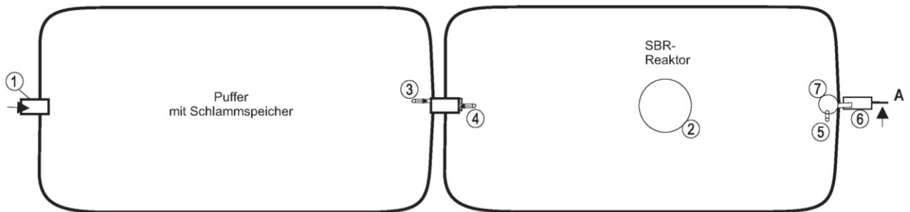
Die Rückstaufreiheit des Zulaufrohres ist sicherzustellen. Unterkante Notüberlauf sowie Unterkante Ablaufrohr dürfen nicht über Unterkante Zulaufrohr liegen.
