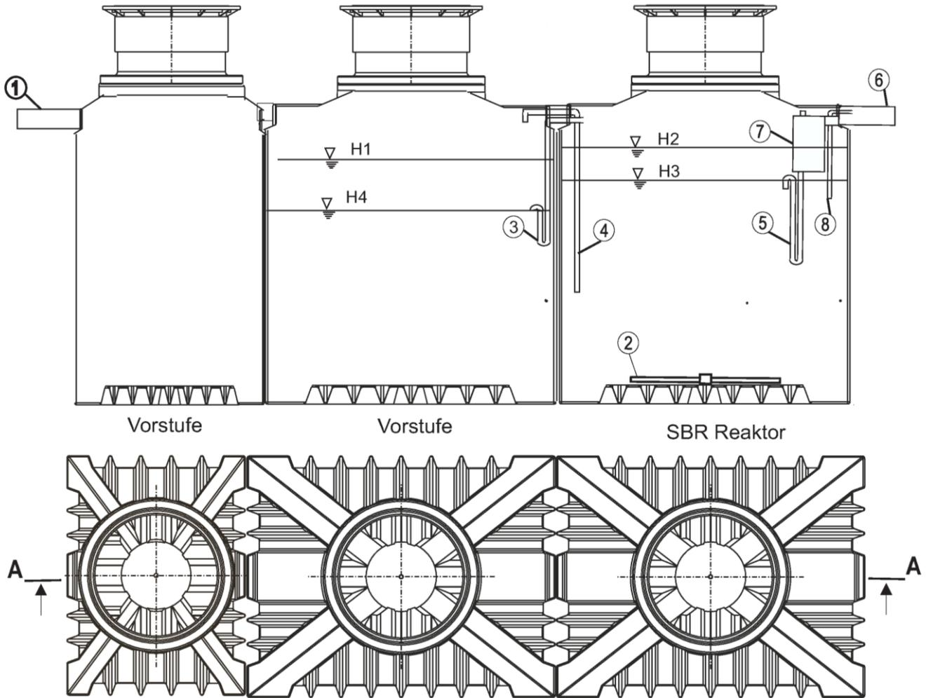
Die Rückstaufreiheit des Zulaufrohres ist sicherzustellen. Unterkante Notüberlauf sowie Unterkante Ablaufrohr dürfen nicht über Unterkante Zulaufrohr liegen.
