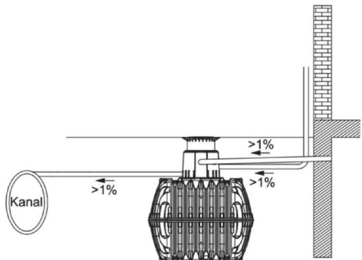
Anwendungsbestimmungen für Kleinkläranlagen nach DIN EN 12566-3 mit CE-Kennzeichnung: Belebungsanlagen im Aufstaubetrieb; Ablaufklasse N
