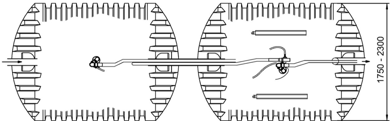
Grobfang / Schlammspeicher / SBR können aus einer oder mehreren Kammern bzw. einem oder mehreren Behältern bestehen.
