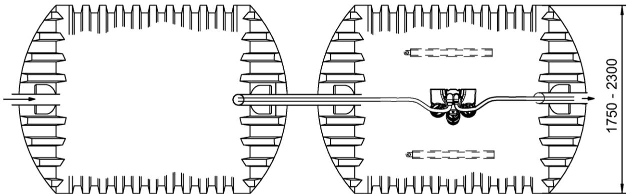
Grobfang / Schlammspeicher können aus einer oder mehreren Kammern bzw. einem oder mehreren Behältern bestehen.
