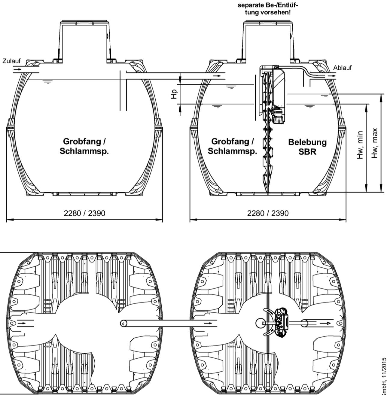
Grobfang / Schlammspeicher können aus einer oder mehreren Kammern bzw. einem oder mehreren Behältern bestehen.
