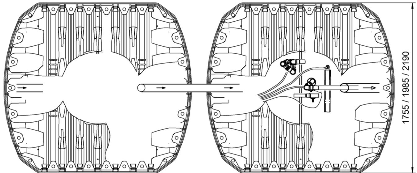
Grobfang / Schlamm-speicher können ein- oder mehrkammerig ausgeführt sein.
