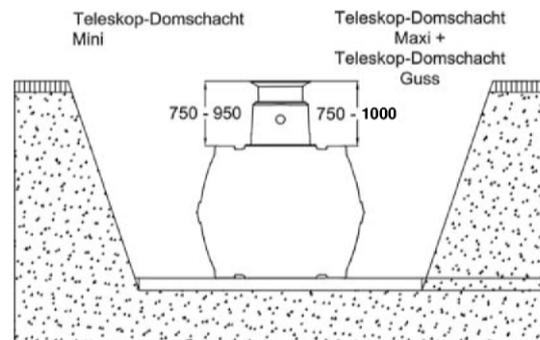
Anwendungsbestimmungen für Kleinkläranlagen nach DIN EN 12566-3 mit CE-Kennzeichnung: SBR-Anlagen Typen PUROO<sup>®</sup>, AQUAPRIMO<sup>®</sup> K eco, Ablaufkl. C
