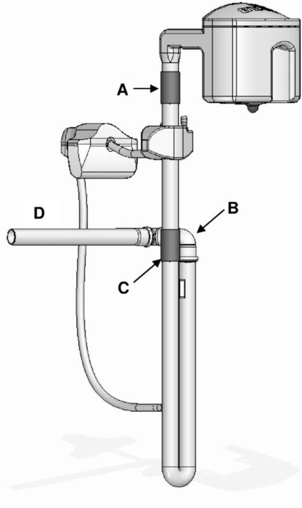
Die Überlaufschikane wird vormontiert geliefert und ist im Behälter zusammenzusetzen.
