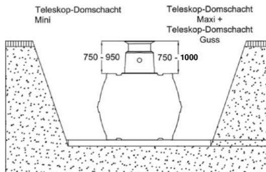
Anwendungsbestimmungen für Kleinkläranlagen nach DIN EN 12566-3 mit CE-Kennzeichnung PUROO® Complete und AQUAPRIMO® K eco Complete, Ablaufklasse C
