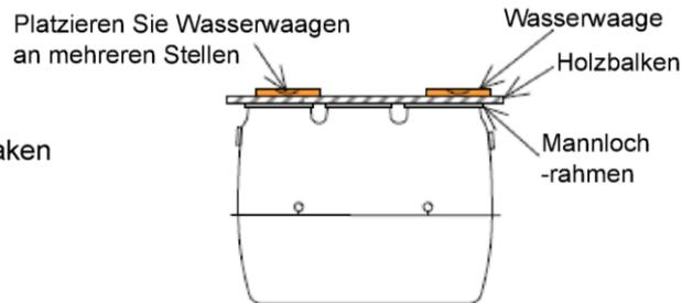
Ausrichten der Anlage
