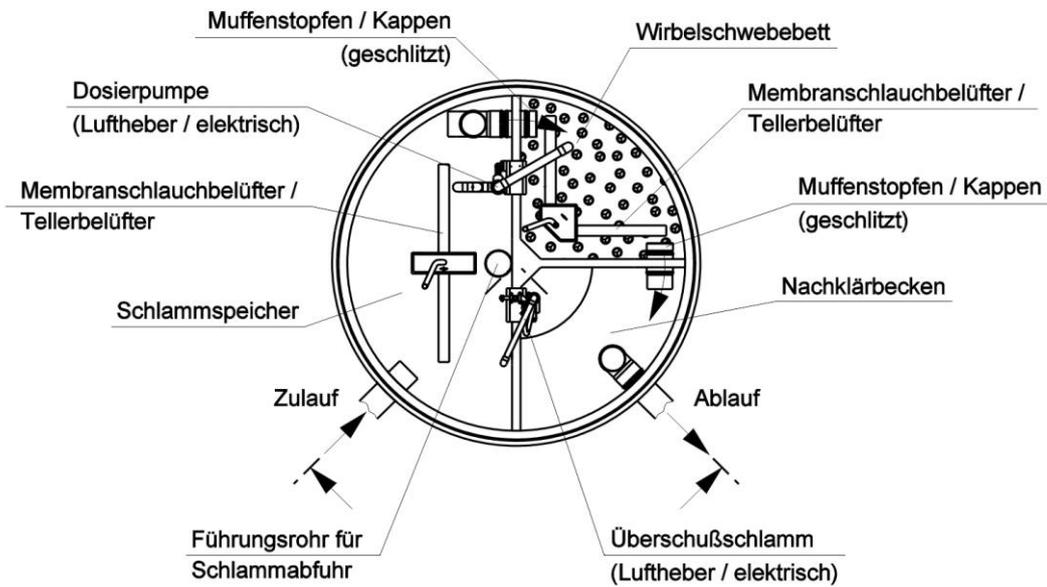
Sämtliche Übergänge im Wirbelschwebbett sind geschlitzt um ein Übertreten der Aufwuchskörper zu verhindern.
