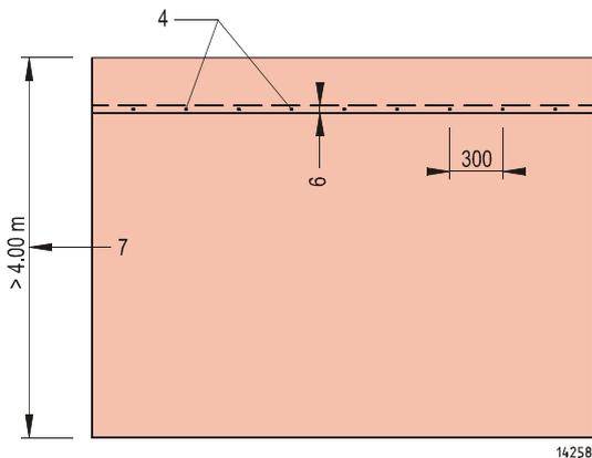
**Schnitt durch Zwischenbefestigung**
