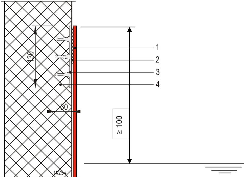
**Sika Waterstop MP AF 130/30 Fugenband, 3-stegig aus EVA** (sämtliche Masse in mm)
