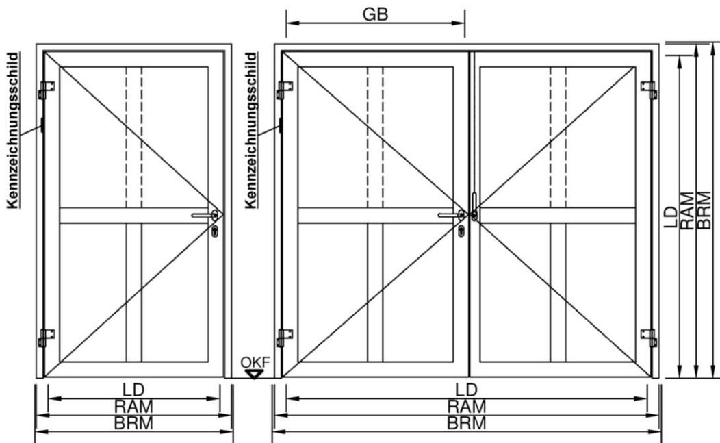
Bei Verwendung eines Falztreibriegels in zweiflügeligen Türen im Zuge von Rettungswegen steht als Rettungswegbreite nur die Öffnungsbreite des Gangflügels zur Verfügung.
