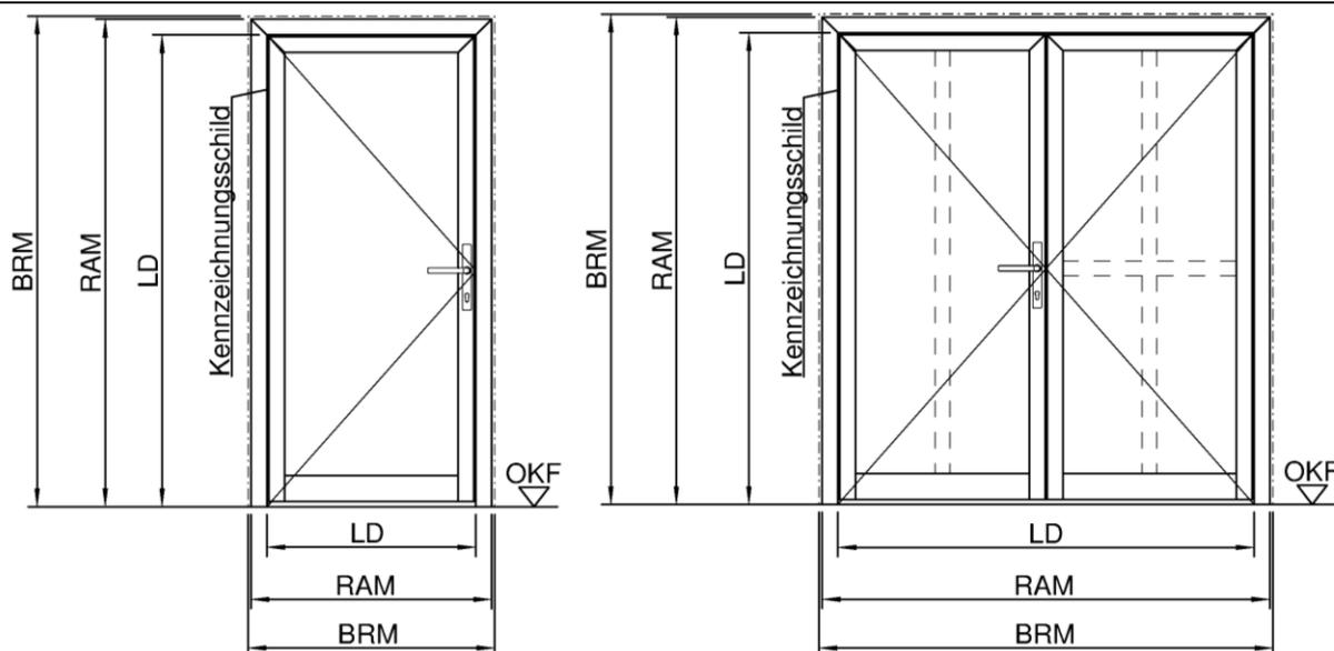
T30-1-RS-FSA Tür und T30-2-RS-FSA Tür immer mit absenkbarer Bodendichtung ausführen und bei Wandanschluss immer beidseitig versiegeln!
