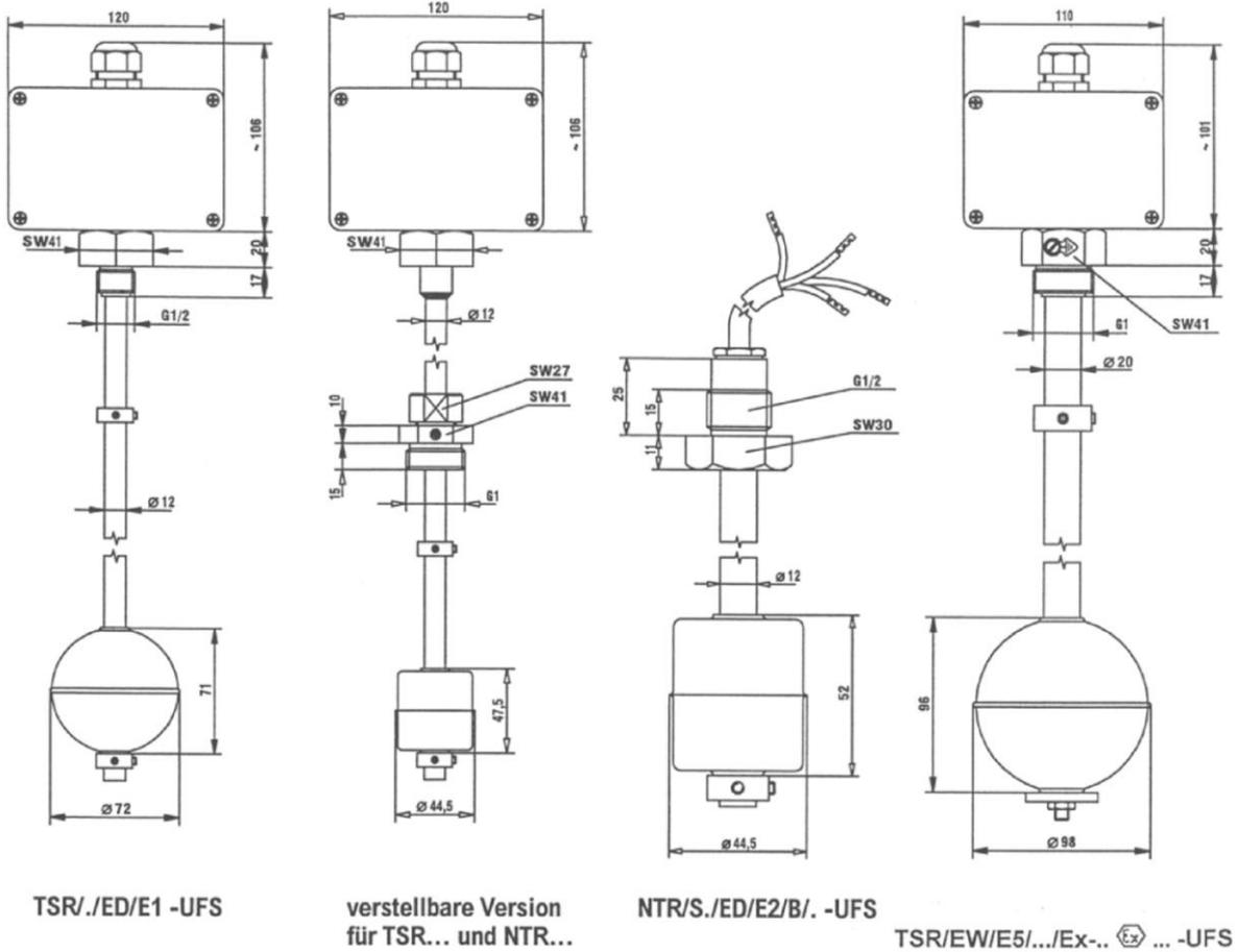
**Schema der Überfüllsicherung**
