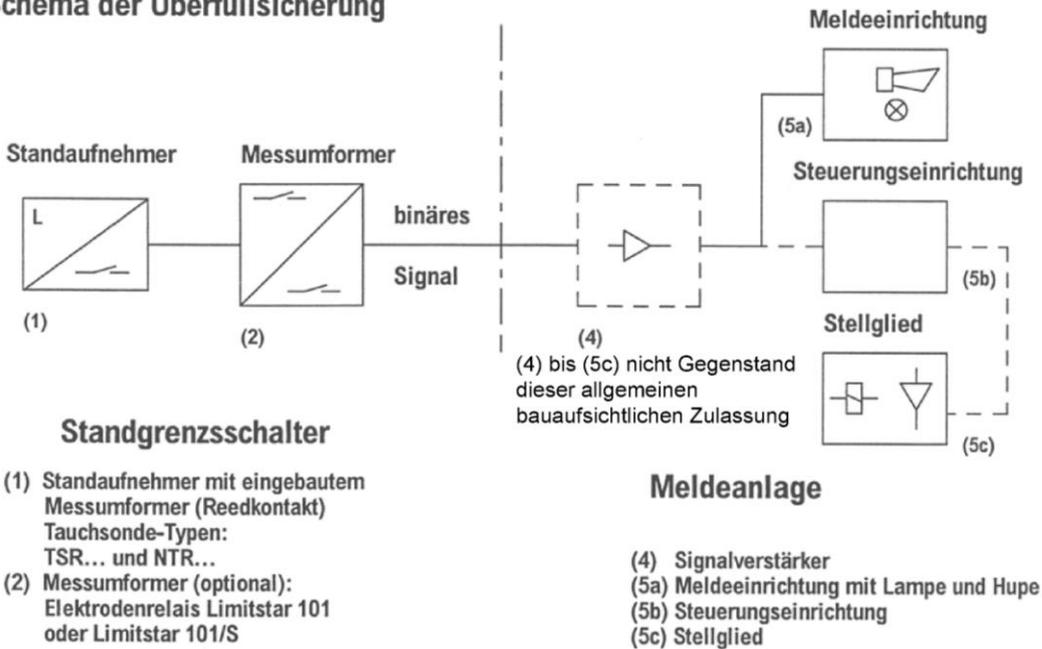
Standaufnehmer (Schwimmerprinzip) vom Typ TSR... und NTR... mit eingebautem Messumformer als Standgrenzschalter von Überfüllsicherungen
