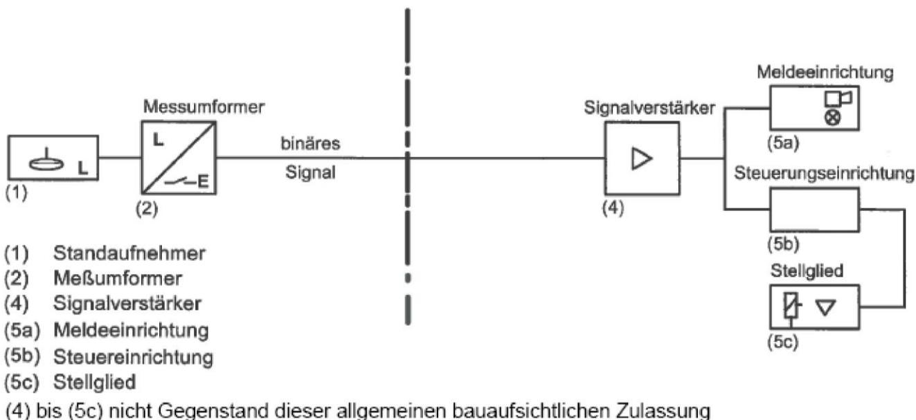
Standaufnehmer mit integriertem Messumformer als Teil von Überfüllsicherungen
