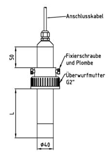
MAXIMAT CX40.... mit Anschlusskopf
