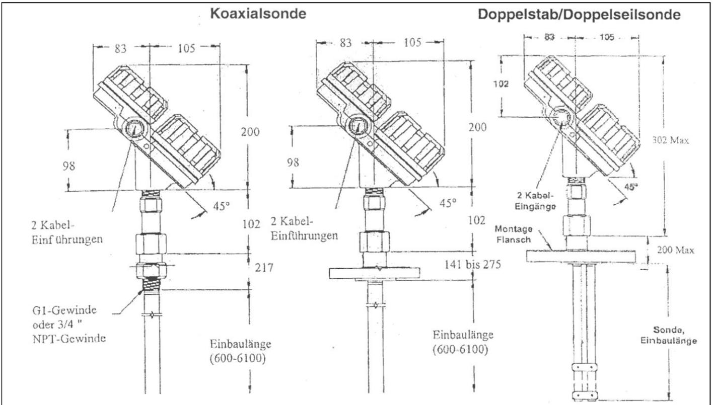
**Schema für den Aufbau von Überfüllsicherungen**
