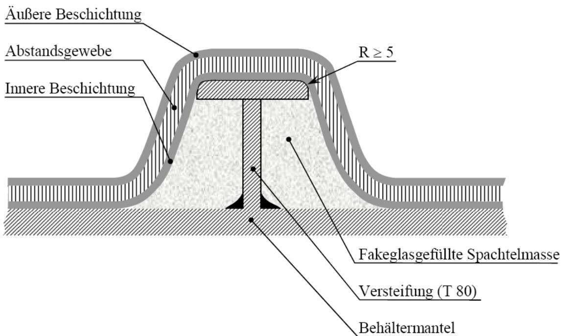
Ausführung im Bereich der Aussparung von innenliegenden Verstärkungsringen bei liegenden Behältern aus Stahl nach DIN 6608 und 6625.
