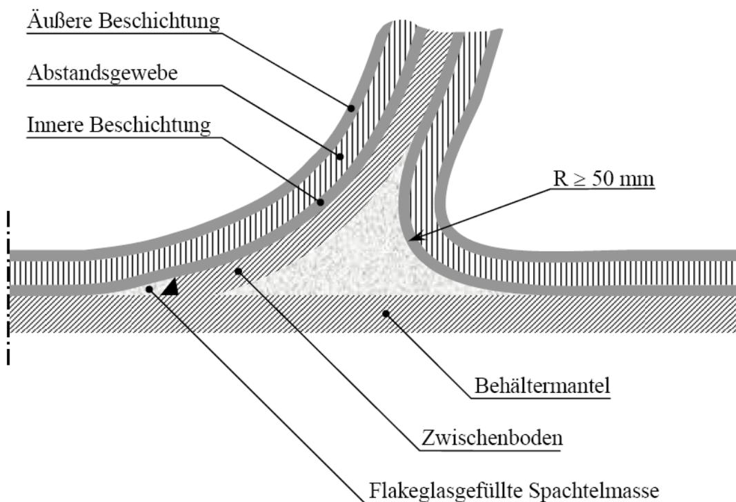
Doppelwandige Leckschutzauskleidung "BÜCOCONTROL" als Bestandteil eines Leckschutzsystems für Tanks aus metallischen Werkstoffen
