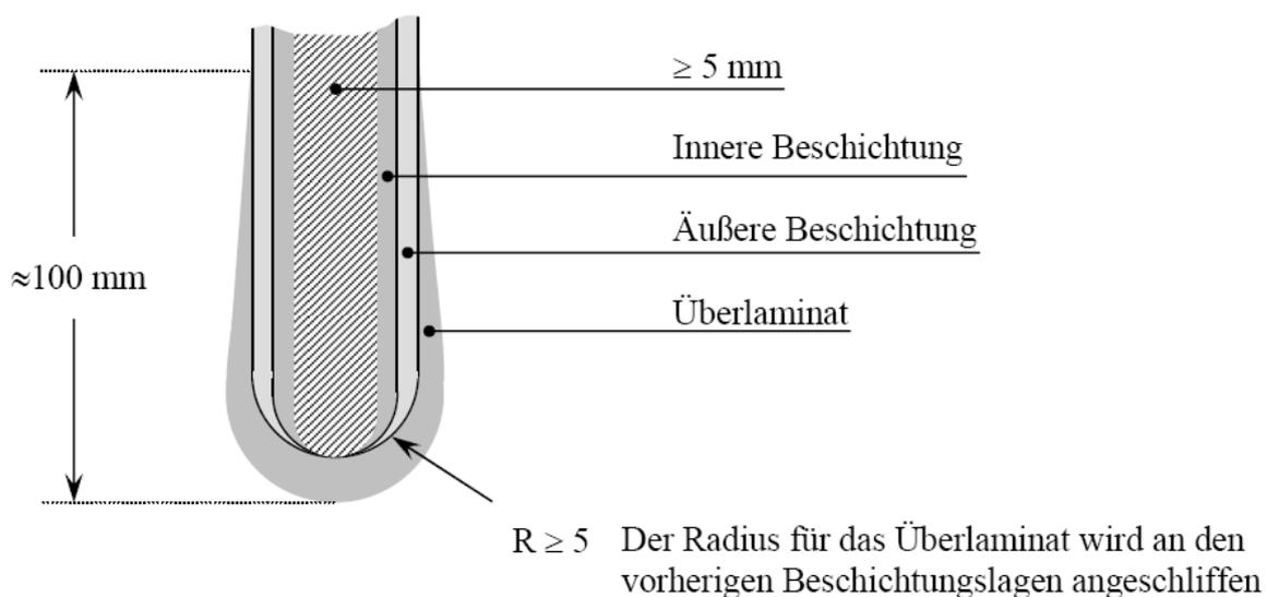
Doppelwandige Leckschutzauskleidung "BÜCOCONTROL" als Bestandteil eines Leckschutzsystems für Tanks aus metallischen Werkstoffen
