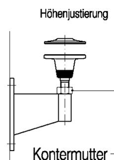
4.) Aufschrauben der vorderen Punkthalter auf die Glasplatte.
