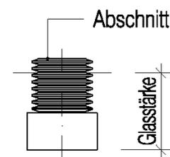
Mittiges Einlegen des Eingußteils in die Glasbohrung.
