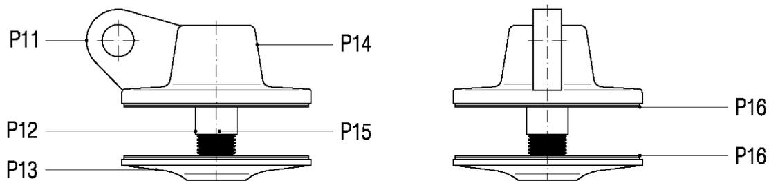
Komponente GM06: Punkthalter zur Befestigung an unterer Wandkonsole
