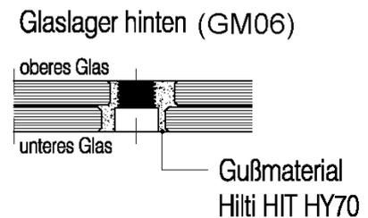
Ausfüllen des Abstandes zwischen Eingußteil und Bohrungsrand mittels HILTI HIT HY70
