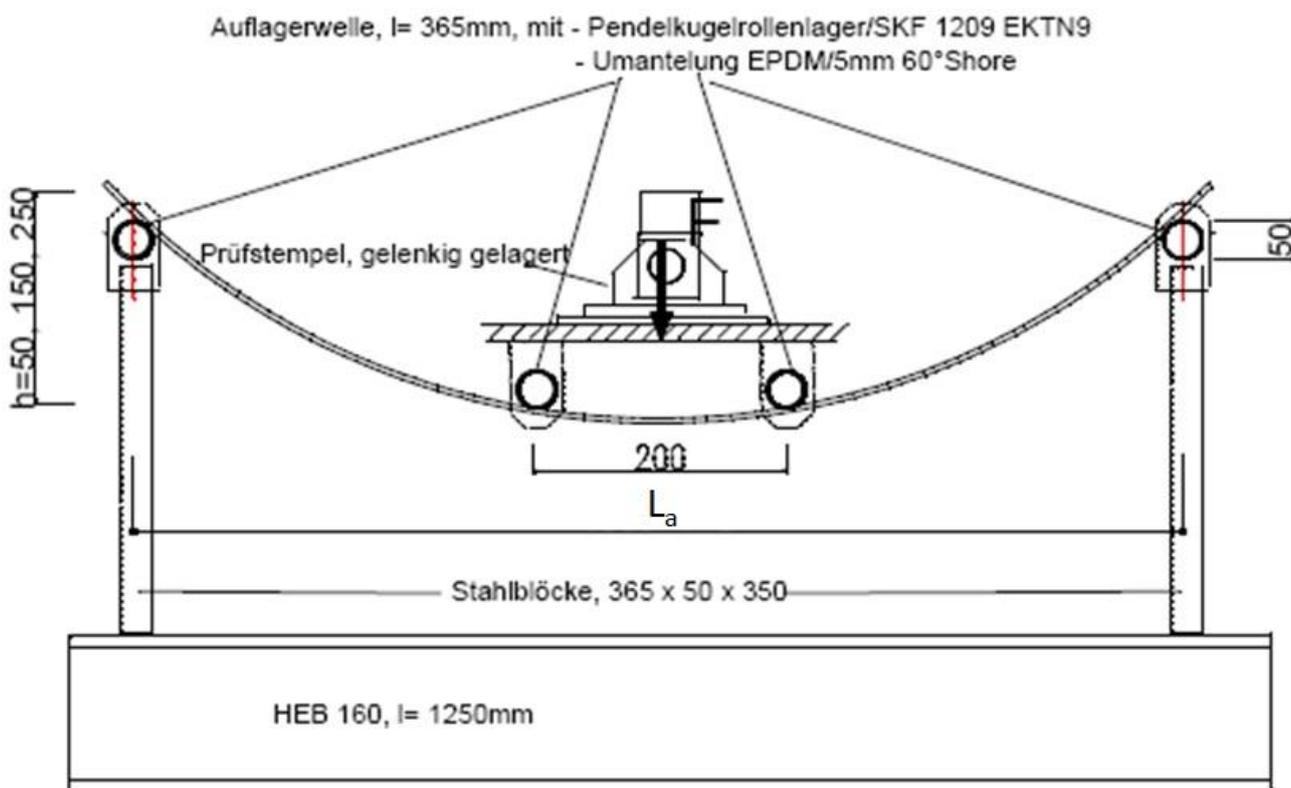
Probekörperabmessungen und Versuchskonfiguration
