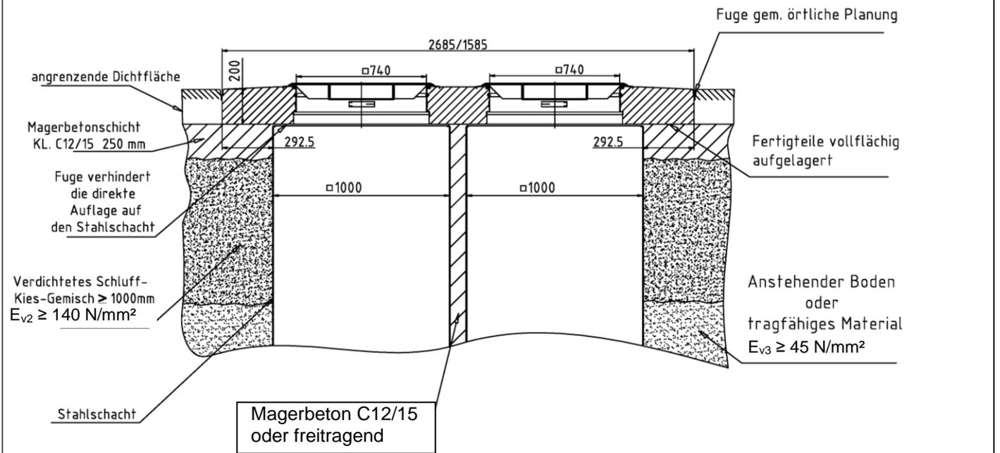
Abbildung 2: Ausbildung des Auflagers für Doppelkranzelemente
