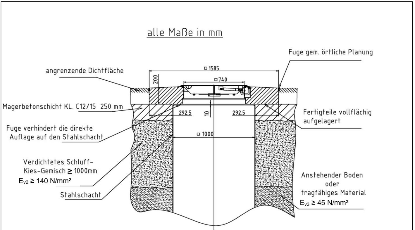
Abbildung 1: Ausbildung des Auflagers für Einzelkranzelemente
