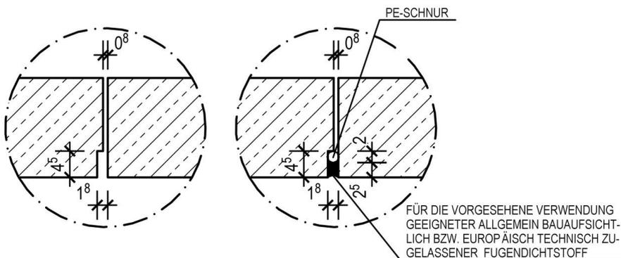
**Fugendimensionierung** zwischen den Rinnenfertigteilen und zwischen der anschließenden Dichtkonstruktion und den Rinnenfertigteilen
