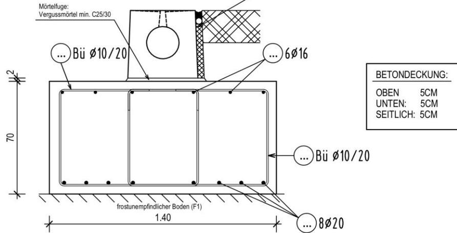
**BEACHTEN:** KIPPSICHERHEIT DER RINNE DURCH SEITLICHEN KONTAKT MIT DER FAHRBAHNPLATTE BZW. FUGENFÜLLUNG
