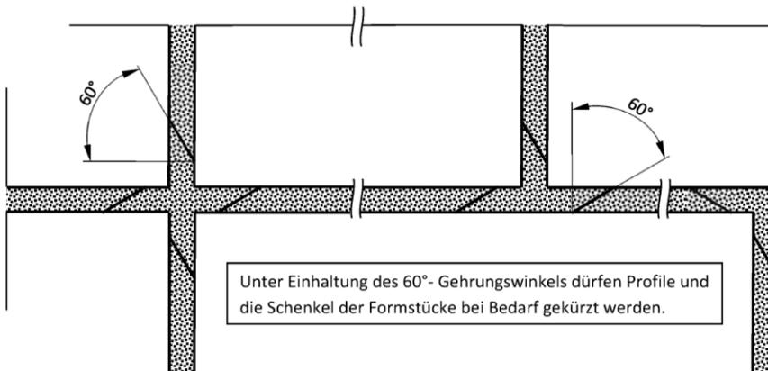
Unter Einhaltung des 60°-Gehrungswinkels dürfen Profile und die Schenkel der Formstücke bei Bedarf gekürzt werden.
