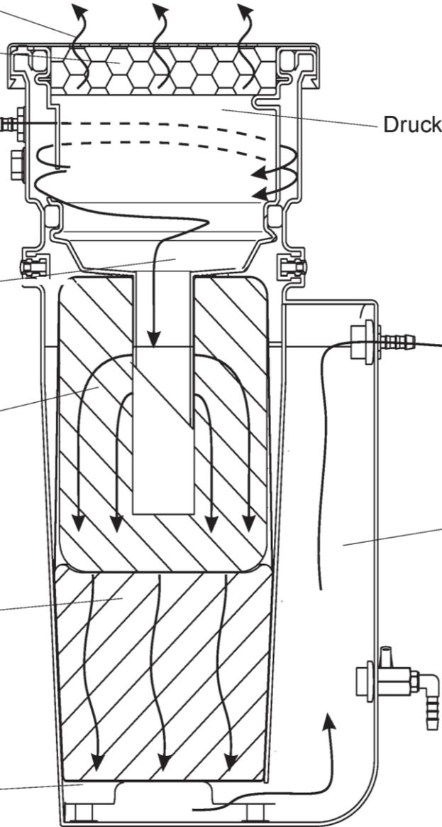
Anlage zur Behandlung von Kompressorenkondensat
