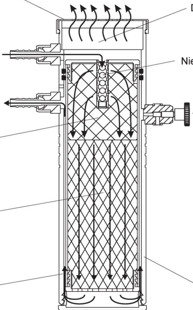
Anlage zur Behandlung von Kompressorenkondensat
