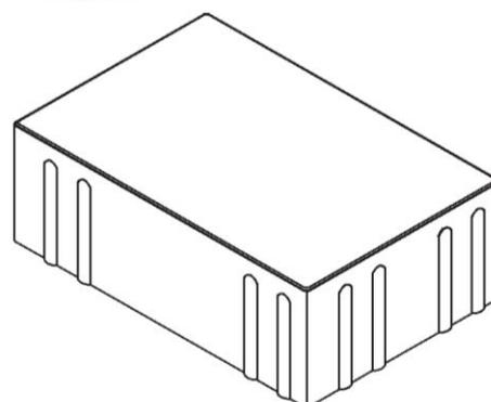
**Vorderansicht Betonpflasterstein 360/240/120 mm**
