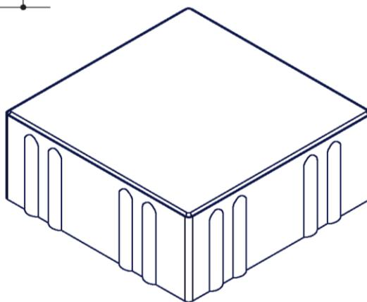
**Vorderansicht Betonpflasterstein 200/200/80 mm**
