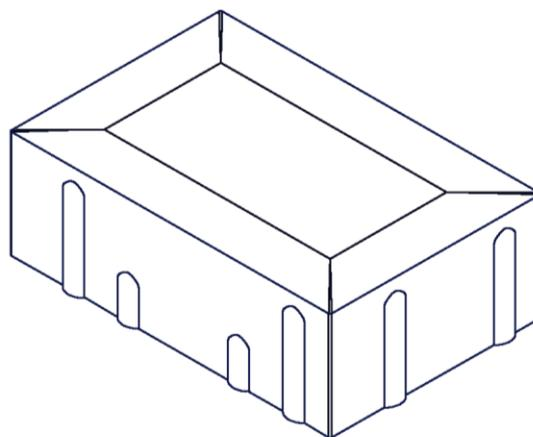
**Vorderansicht Betonpflasterstein 240/160/80 mm**
