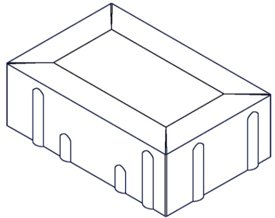
Vorderansicht Betonpflasterstein 240/160/80 mm
