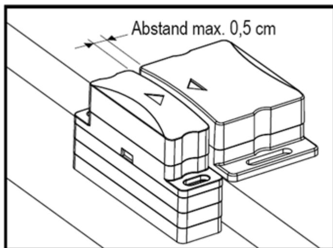
Magnetkontakt/Positionierung des Sensors
