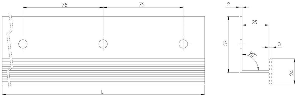
**Vertikales Verbindungsprofil – "Verbindungsleiste PVC"** (Abmessungen in mm)
